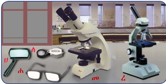
ስእሊ 2.1 ዝተፈላለዩ ዓይነታት ቀሊል ማይክሮስኮፕ፡- ('ሀ' ን 'ሐ' ን መግዘፊ ሌንስታትን 'መ' መንበሊ መነጻጸር) ክምሕ' ውን ዝተፈላለዩ ዓይነታት ኮምፓውንድ ማይክሮስኮፕ ('መ' ክልተኣዊ መርኣዩ 'ረ' ሓደኣዊ መርኣዩ)
